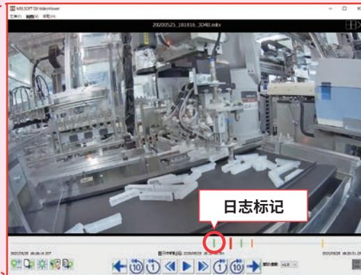
通过与GX LogViewer和GX Works3共享日志标记,可基于实际设备的运行影像和波形图确认出错原因。同时,可以跳转至可能造成问题的程序,提高调试作业效率。
