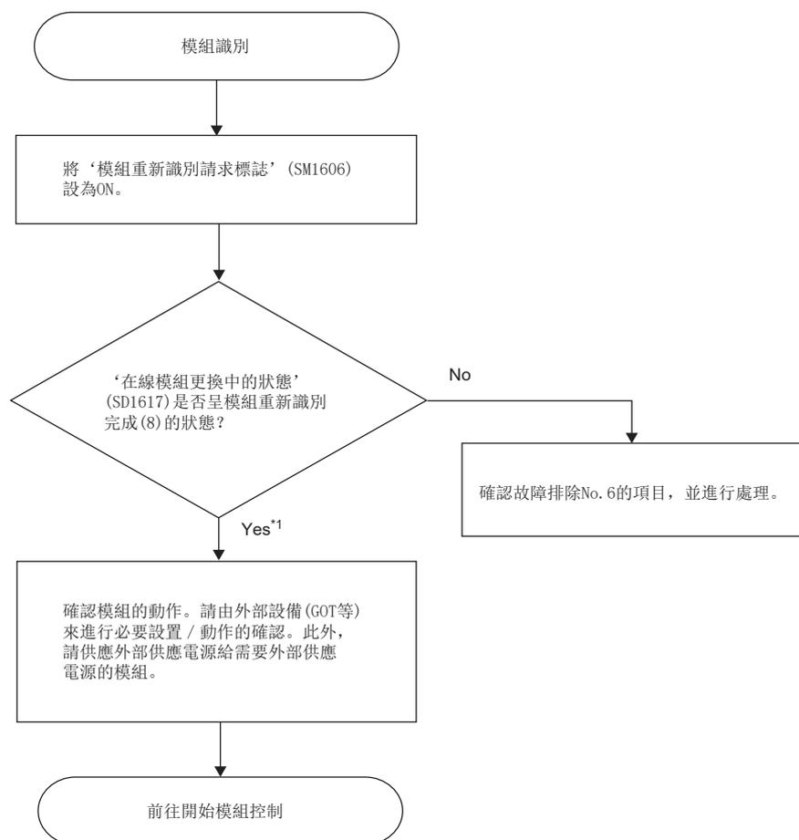
\*1 透過工程工具的模組參數進行初始設定的情況下，在RUN LED亮燈的時機將反映模組參數的設定內容。
