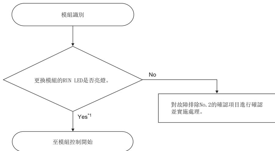
\*1 透過工程工具的模組參數進行初始設定的情況下，在RUN LED亮燈的時機將反映模組參數的設定內容。
