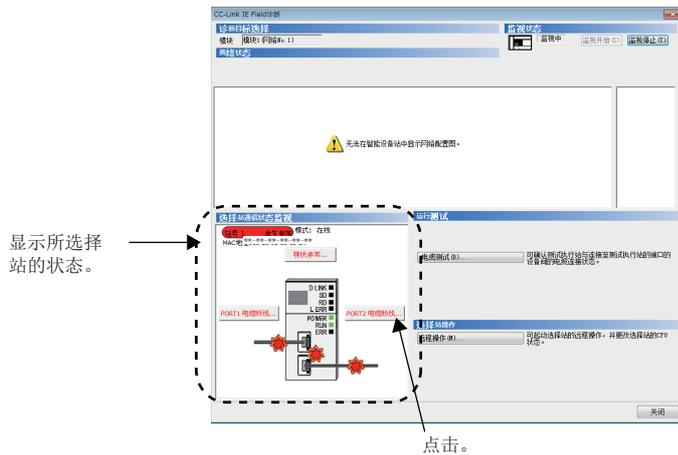
4. 通过画面右下角的“运行测试”、“选择站操作”，可以进行电缆测试及远程操作。(☞ 118页 电缆测试, 118页 远程操作)
