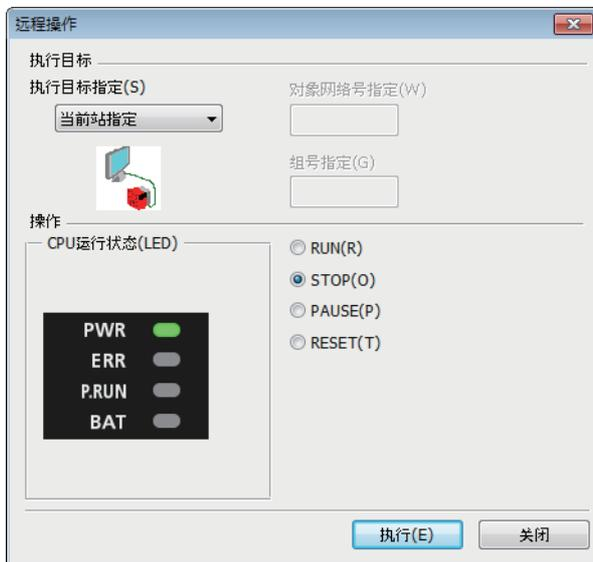
1. 点击“CC-Link IE Field诊断”画面的[远程操作]按钮。
