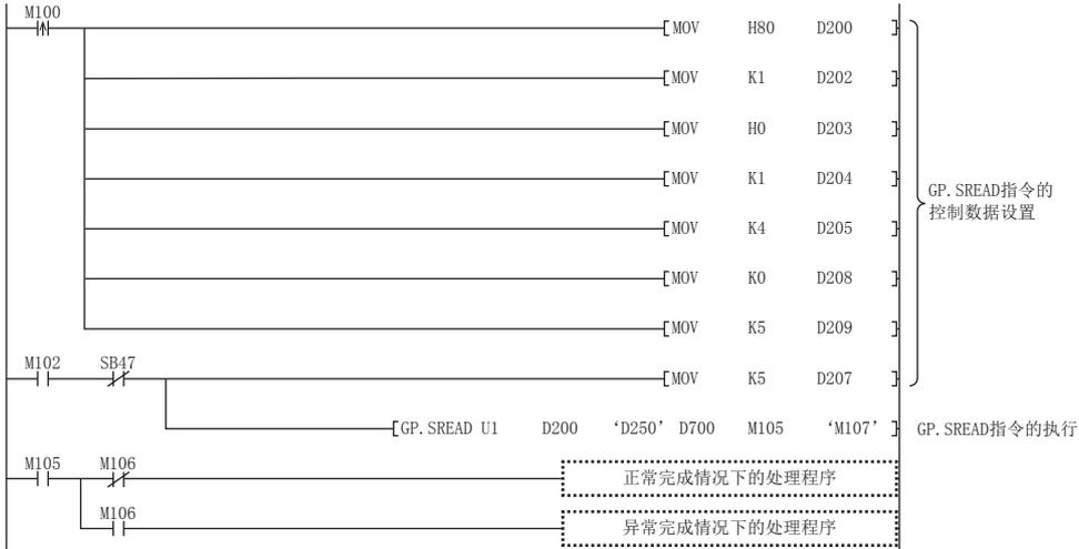
将下述程序写入对象站(站号4)的CPU模块中。
