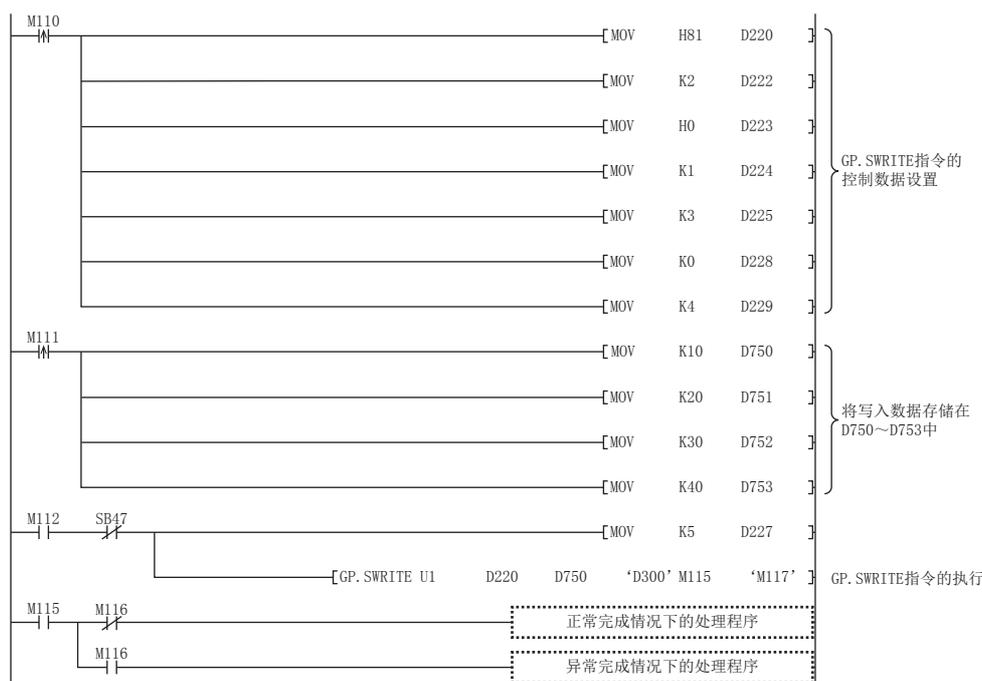
将下述程序写入对象站(站号3)的CPU模块中。
