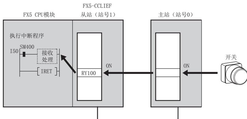
按下述方式设置FX5-CCLIEF(站号1)的“中断设置”。
