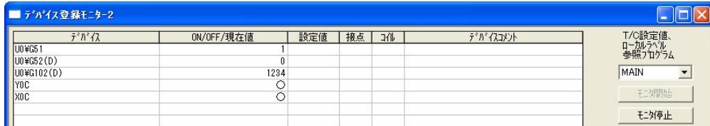
図7.7.4-1 デバイス登録モニタ画面(本ユニットがスロット0に装着された場合の例)
