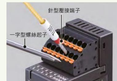
採用彈簧夾式端子台設計, 接線快速又簡單。最大連接線徑 1.5mm<sup>2</sup>, 可以連接針型壓接端子或標準電線。
