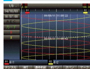
連続収録の開始、停止操作を前面のボタン (F3) を使ってワンタッチで操作できます。\*1
