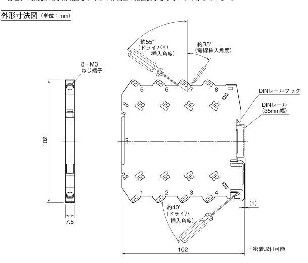
※1、ドライバの軸径は、6mm以下のものを使用して下さい。
