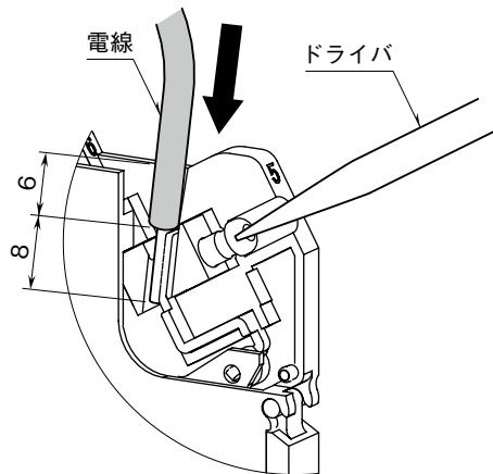
・電線の被覆は 8 mm 剥離して下さい。
