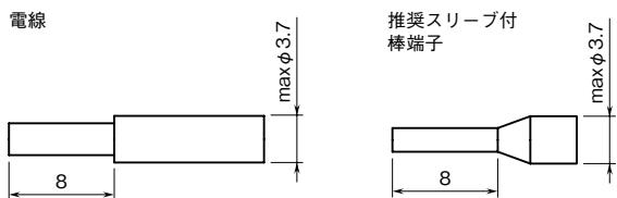
電線の先が奥に当たるまで挿入し、ドライバでねじを締めて下さい (ねじ締付トルク : 0.3 N·m)。
