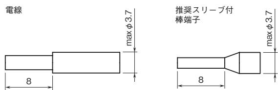
電線の先が奥に当たるまで挿入し、ドライバでねじを締めて下さい。(ねじ締付トルク : 0.3 N·m)。
