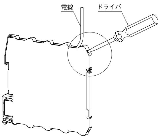
電線の先が奥に当たるまで挿入し、ドライバでねじを締めて下さい (ねじ締付トルク : 0.3 N·m)。
