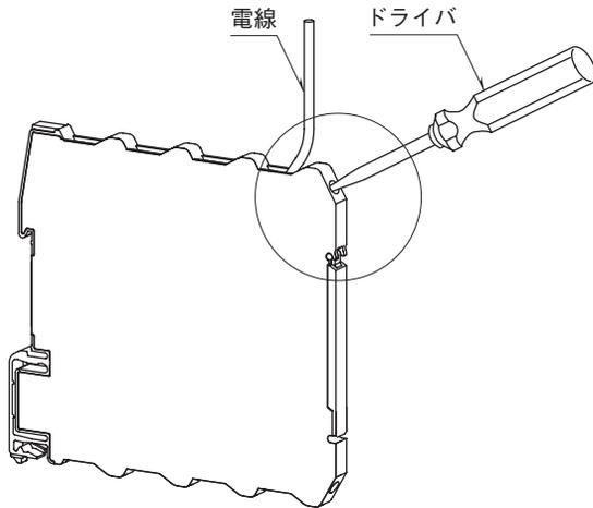
電線の先が奥に当たるまで挿入し、ドライバーでねじを締めて下さい (ねじ締付トルク : 0.3 N・m)。
