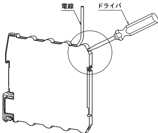
電線の先が奥に当たるまで挿入し、ドライバーでねじを締めて下さい。
