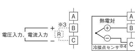
※3、電流入力時は抵抗モジュール（形式：REM4）を取付けて使用します。
