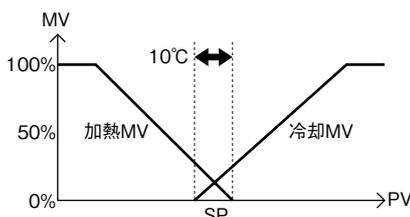
注) 図はわかり易くするために P 動作時の MV 動作を表していますが、I、D が設定されている場合は、加熱 MV / 冷却 MV の切りかわりが SP と一致しないため、図の通りにはなりません。
