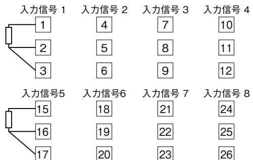
未使用的入力端子に抵抗器が接続されていない場合、ERR表示ランプが赤色に点灯し、PLC等にバーンアウトフラグがセットされます。
