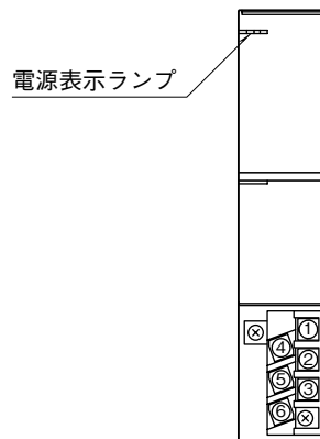
電源表示ランプ：緑色 LED、電源供給時点灯
