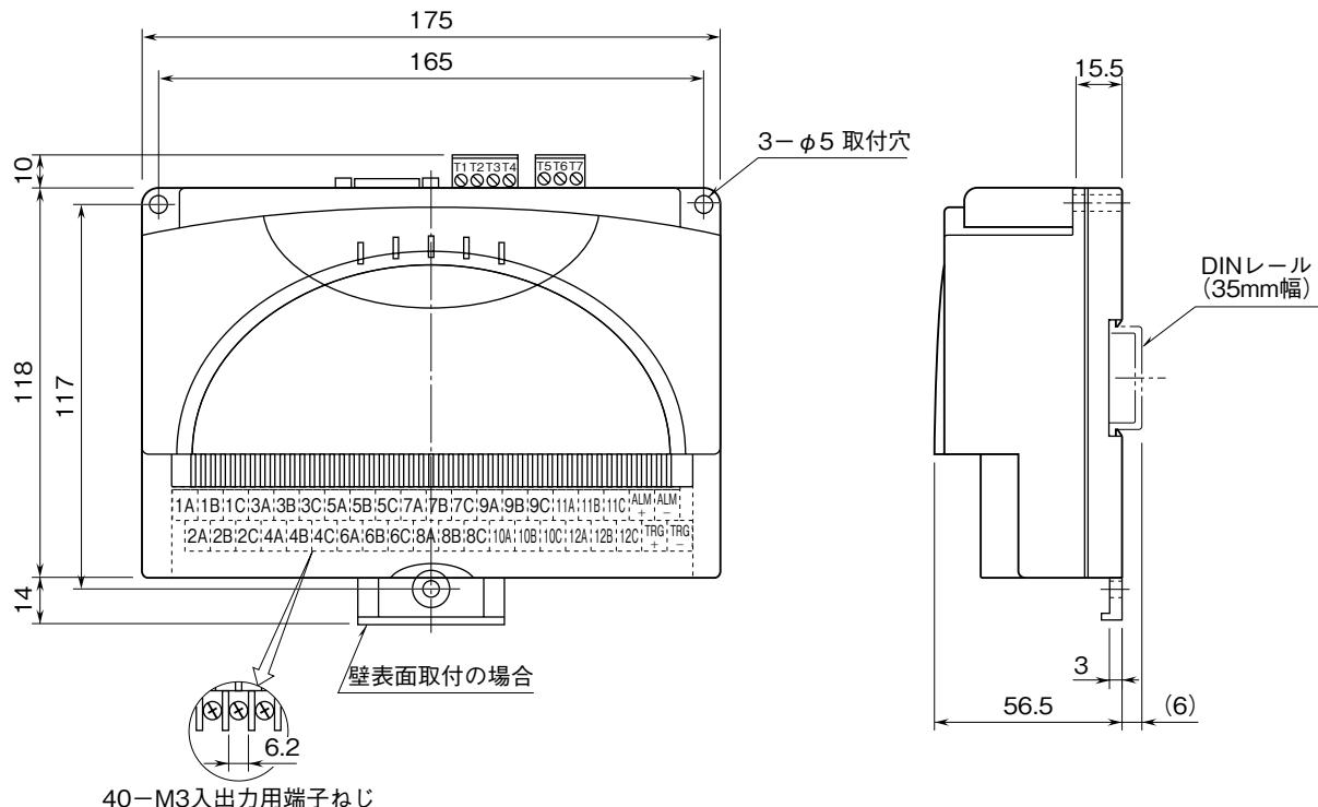
注) 水平でなく垂直のDINレールに取付ける場合、重力による滑り落ち防止のために、オムロン製 エンドプレート（形式：PFP-M）、IDECK製 止め金具（形式：BNL6）などの固定金具のご使用をおすすめします。
