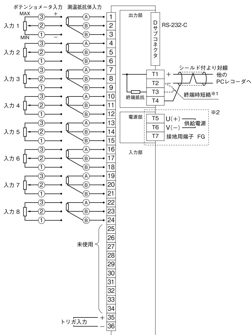
※1、より対線の伝送ラインが終端の場合は(=渡り配線がない場合)、端子T2、T3間を付属のショートチップ(または配線)で短絡して下さい。
