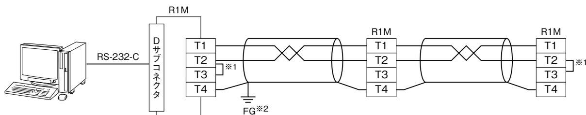
※1、回路の終端となる場合に、内部の終端抵抗を使用します。
