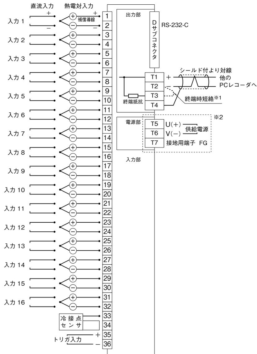
※1、より対線の伝送ラインが終端の場合は(=渡り配線がない場合)、端子T2、T3間を付属のショートチップ(または配線)で短絡して下さい。ユニットが伝送ラインの途中に配線されているときは、端子T2、T3間のショートチップをはずして下さい。
