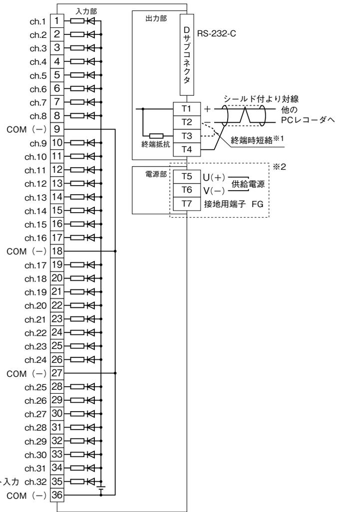
※1、より対線の伝送ラインが終端の場合は（＝渡り配線がない場合）、端子T2、T3間を付属のショートチップ（または配線）で短絡して下さい。ユニットが伝送ラインの途中に配線されているときは、端子T2、T3間のショートチップをはずして下さい。
