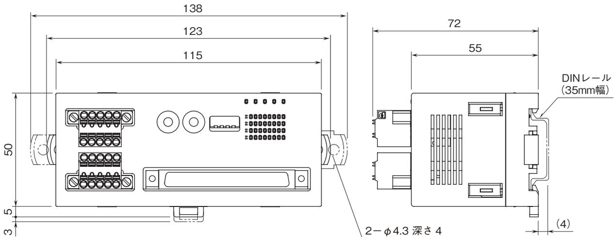
取付寸法図(単位:mm)
