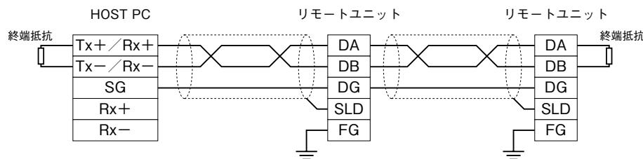
両端のユニットには、必ず同様の“終端抵抗”を接続して下さい。
