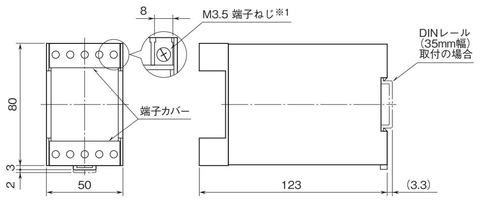
※1、端子ねじの配置は、端子接続図を参照して下さい。
