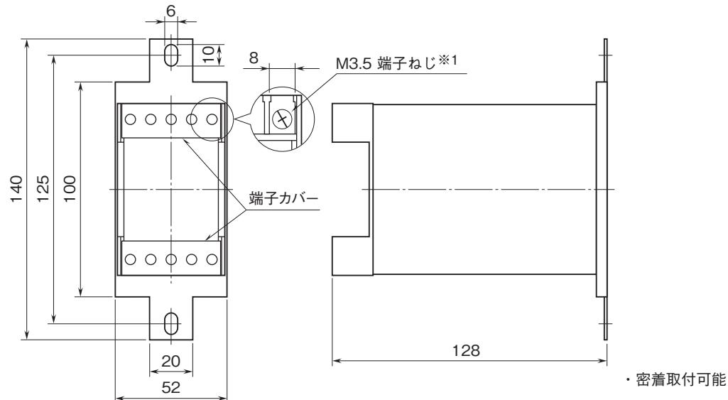
※1、端子ねじの配置は、端子接続図を参照して下さい。
