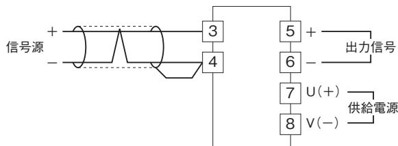
注) 本器は超高速形のため原理的に測定範囲内の周波数成分の入力信号に含まれるノイズだけを変換器内で減衰させることはできません。したがって‘シールド付より対線’を使用するなど入力信号にノイズが混入しないように十分ご注意下さい。
