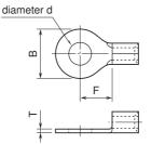
d: M5 use  $B \le 12.5 \text{ mm}$   $F \ge 7.0 \text{ mm}$
