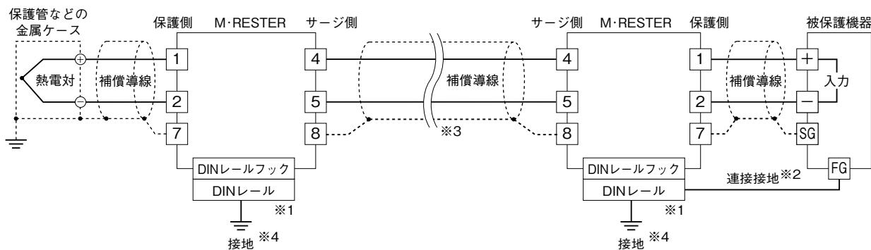
※1、アルミニウム製DINレールは、酸化皮膜によって本器と接地の導通性を阻害する恐れがあります。鉄や銅製のレールをご使用下さい。
