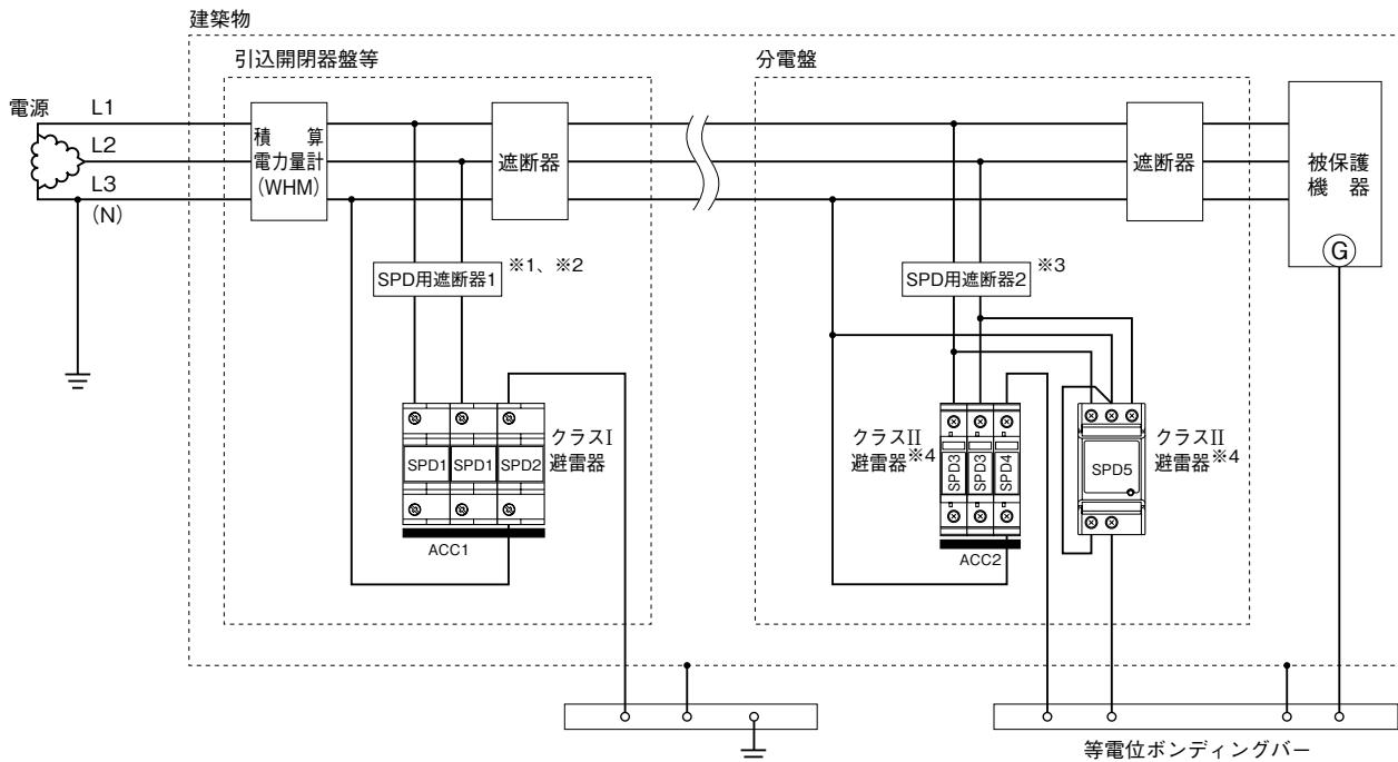
※1、定格電流150Aで、定格遮断容量が30kAまたは規約短絡電流のいずれか大きい値の遮断器を選定して下さい。また遮断器の警報スイッチ(AL)を利用して、遮断器の動作を監視することをお勧めします。
