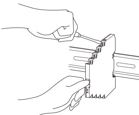
端子の締付け、緩め作業は前面に手を添えて行って下さい。
