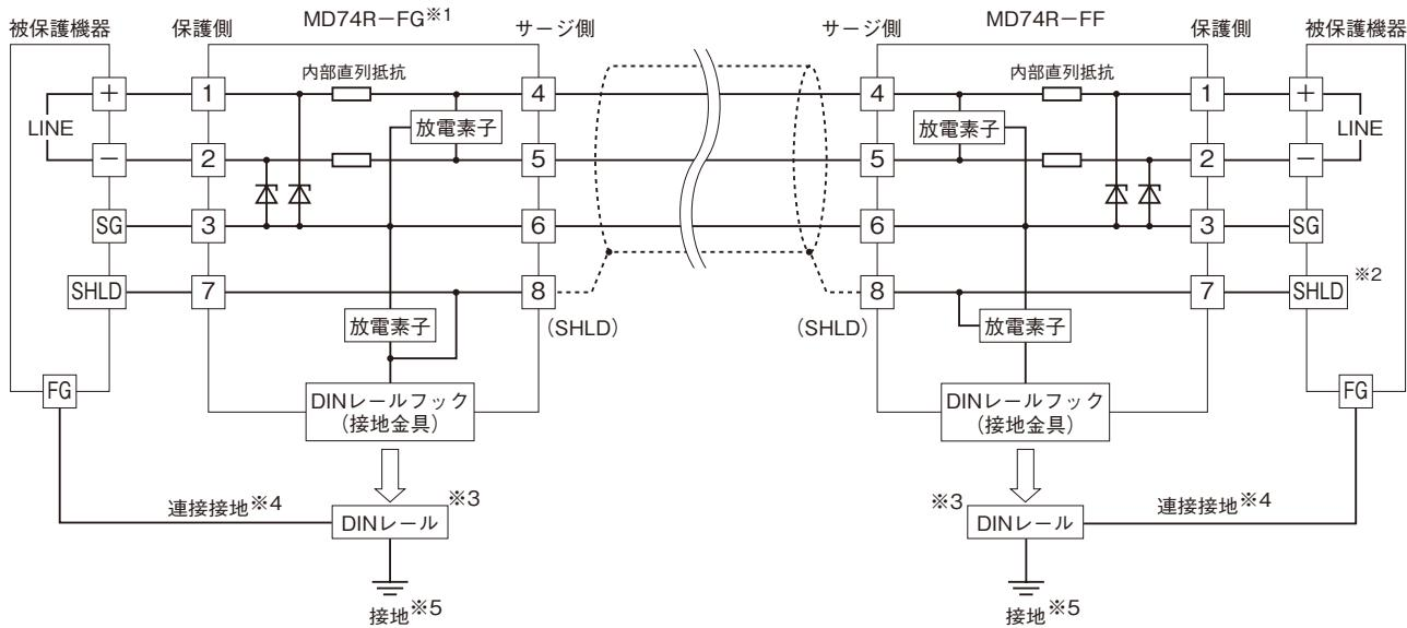
※1、シールド線を接地する場合は、MD74R-FGをご選定下さい。避雷器内部でシールド線がDINレールフックにつながります。
