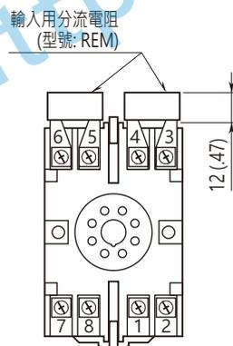
電流輸入時端子上連接輸入分流用電阻。
