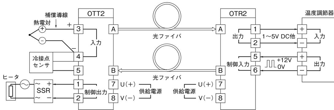
OTT2 は熱電対の信号を光の点滅パルスに変換し、光ファイバを伝送路として OTR2 に送信します。
