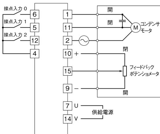
注) リミットスイッチを介してモータ結線をした場合、スイッチが動作するたびにSSRに過度のストレスがかかる可能性がありますのでご注意ください。
