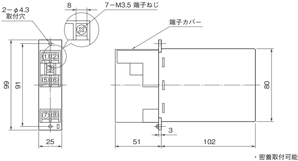
取付寸法図(単位:mm)
