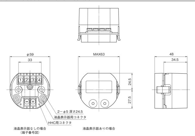
注)液晶表示器の取外しのため、指が入る寸法間隔で取付けて下さい。
