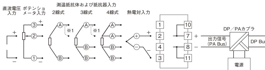
※1、測温抵抗体および抵抗器入力で、2線式および3線式の場合、①-②端子間を短絡して下さい。
