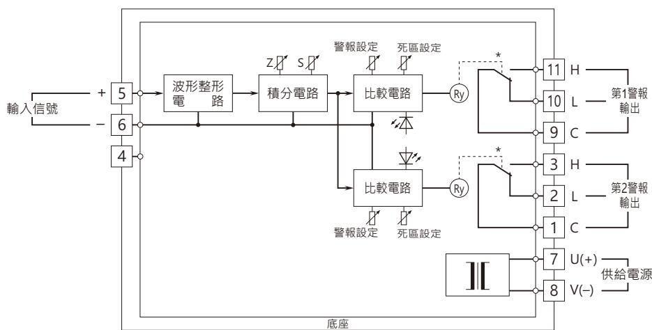
\* 警報輸出代碼為“1”、“4”時, 供給電源 OFF時的接點狀態。
