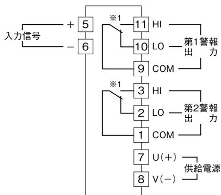
※1、警報出力コード“1、4”のときの電源OFF時の接点状態です。
