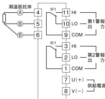
※1、警報出力コード“1、4”的ときの電源OFF時の接点状態です。
