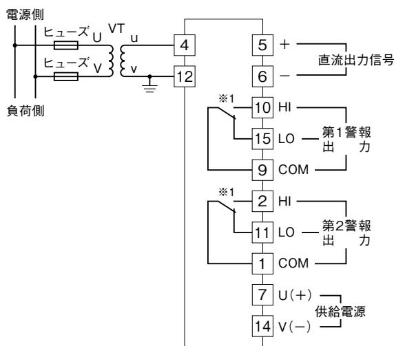
※1、警報出力形式コード“1、4”のときの電源OFF時の接点状態です。
