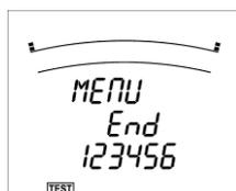
計測モードで **SET** ボタンを長押しして、設定確認メニューに移行、メニューから 9 を選択するとテストメニューに移行します。テストメニューは 1~6 と End の 7 つのメニューをもち下表のようなテストが行えます。
