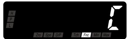
**2** **Alarm/↓** または **Scale/↑** を押して入力補正 A 入力値に移動する
