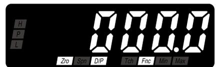
**3** **Shift** を押して、入力補正 A 入力値を変更可能にし、**Shift** および **Up** で設定する
