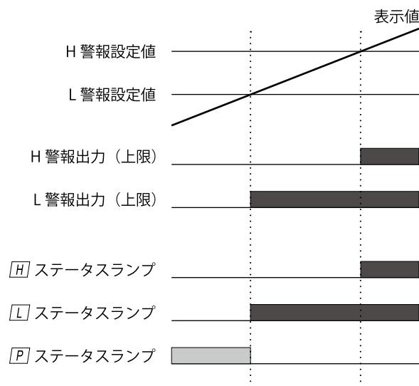
各警報出力に対し下限警報または上限警報を自由に設定できますが、警報判定ステータスランプは各警報出力に対して L、H 固定となっています。そのため、たとえば、L 警報出力の動作を上限警報に設定した場合でも警報時は L ステータスランプが点灯します。
