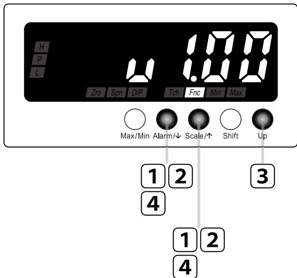
**1** **Alarm/↓** と **Scale/↑** を同時に長押しして詳細設定モードに移行する（3秒以上）
