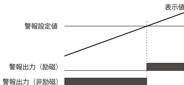
たとえば、しきい値に達した場合に運転を停止（OFF）したいときは、出力論理を反転させる「非励磁」に設定します。
