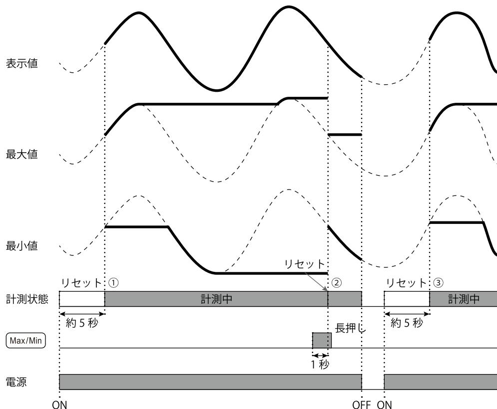
①電源投入 (ON) 後約 5 秒間、内部メモリがリセットされ、その後、最大値・最小値の計測を開始します。
