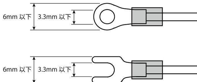
適用電線 : 0.25 ~ 1.65mm<sup>2</sup> (AWG22 ~ 16)
