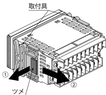
3 端子カバーをパネル取付穴に通します。
