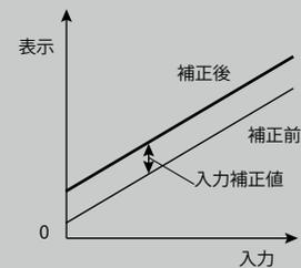
補正後 = 補正前 + 入力補正值
