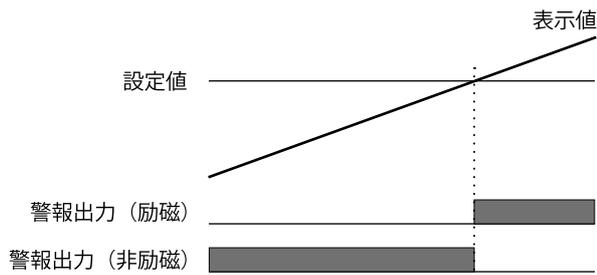
たとえば、しきい値に達した場合に運転を停止 (OFF) したいときは、出力論理を反転 (b 接点) させる「非励磁」に設定します。
