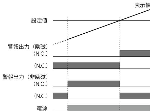
たとえば、電源 OFF 時と警報時に警報出力したい場合は「非励磁」に設定し、N.C. 側の端子を使用します。
