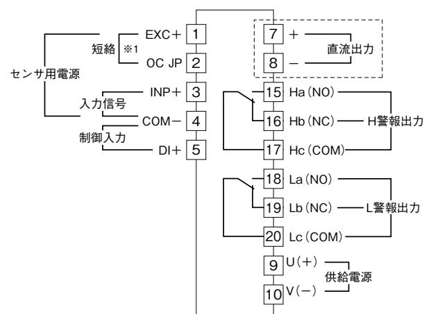
※1、オープンコレクタまたは有接点スイッチ入力の場合に短絡します（入力部接続例のオープンコレクタまたは有接点スイッチ入力参照）。
