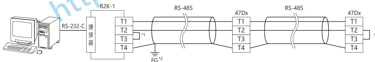
\*1. 當本設備位於傳輸線路末端時，使用內部終端電阻。
