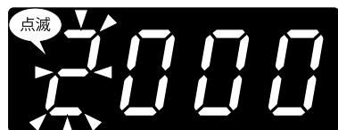
**SHIFT** で設定値を表示し、**SCALE/↑** で 4 衔目が点滅し設定変更可能状態になります。
