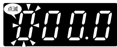
**SHIFT** で設定値を表示し、**SCALE↑** で 4 衔目が点滅し設定変更可能状態になります。
