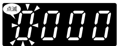
**SHIFT** で設定値を表示し、**SCALE↑** で 4 衔目が点滅し設定変可能状態になります。
