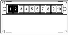
計測する交流電流信号線を接続します。
