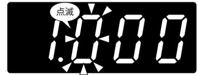
**DISP/↓** または **SCALE/↑** で桁を移動、点滅している桁の数値を **UP** で設定します。
