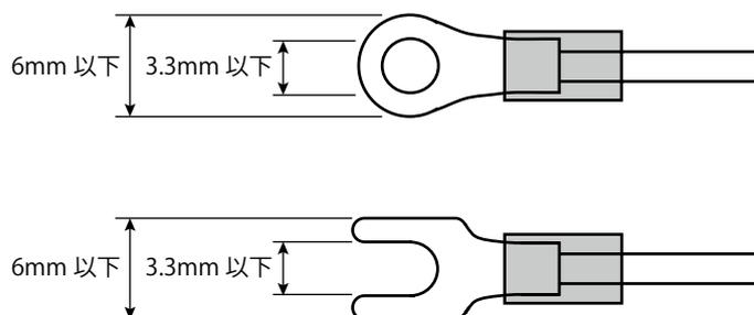
適用電線 : 0.25 ~ 1.65mm<sup>2</sup> (AWG22 ~ 16)
