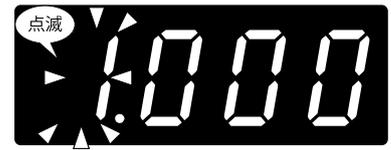
**SHIFT** で設定値を表示し、**SCALE/↑** で 4 桁目が点滅し設定変更可能状態になります。
