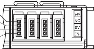
※※ 24V、0V それぞれ同じ記号のピン間は内部でつながっています。一箇所の 24V、0V ピンからまとめて電流供給する場合は、1A 以内としてください。
